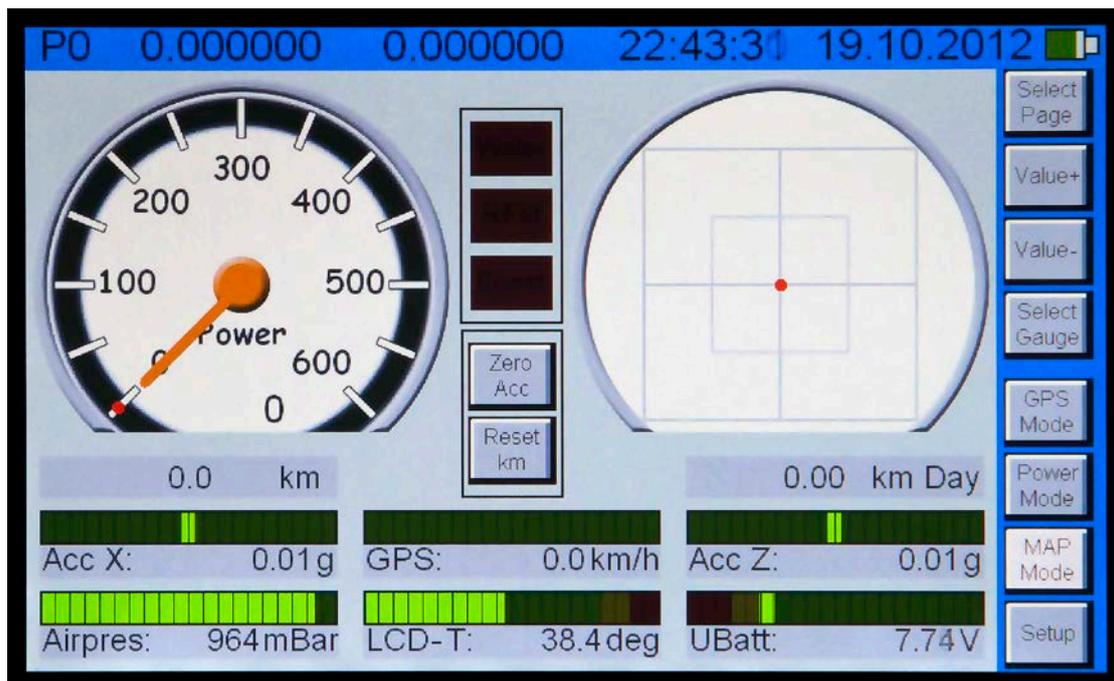
Nach dem Einschalten des Gerätes erscheint je nach Konfiguration oben abgebildete Anzeige. Das Gerät ist ca. 2 Sekunden nach dem Einschalten betriebsbereit. Der GPS-Empfänger braucht je nach Umgebung einige Sekunden, bis mehrere Minuten bis genaue Messdaten geliefert werden.
